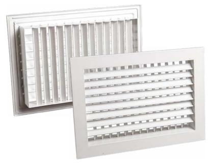
Описание. Двухрядная регулируемая вентиляционная решетка DRG используется в системах приточно-вытяжной вентиляции и кондиционирования. Предназначена для установки в воздуховоды прямоугольного сечения или в любой другой проем. Два ряда каплевидных жалюзи подвижны и могут распределять потоки воздуха вверх/вниз и вправо/влево. Управление жалюзи осуществляется вручную, после выбора положения жалюзи остаются жестко зафиксированными за счет специальной системы.
