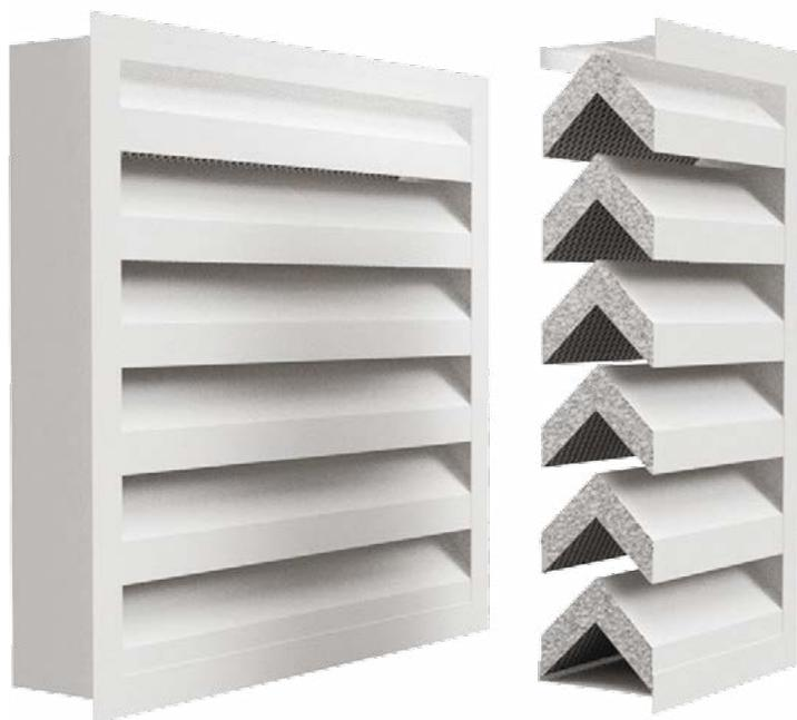
**Описание.** Акустическая решетка OGN2-300/OGWN2-300 выполняет шумопоглощающую, защитную и декоративную функцию. За счет специальной конструкции ламели, решетка препятствует проникновению шума из здания на улицу и наоборот. Имеет также защитные и декоративные функции. Акустическая решетка используется на фасадах промышленных зданий, машинных помещениях, венткамерах, котельных, градирнях.
