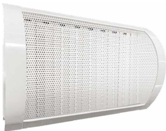
**Описание.** Перфорированная цилиндрическая вентиляционная решетка PGC-R используется в системах приточно-вытяжной вентиляции и кондиционирования. Имеет цилиндрическую форму и предназначена для установки в воздуховоды круглого сечения. Решетка оснащена клапаном расхода воздуха для регулирования объема подаваемого воздуха и точной настройки системы вентиляции в помещении.
