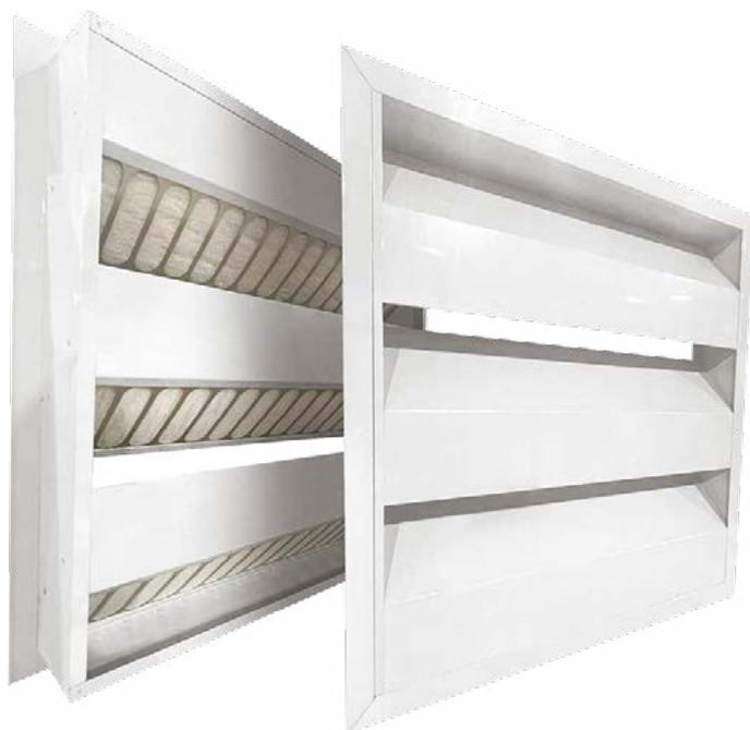
**Описание.** Акустическая решетка OGN1-300/OGWN1-300 выполняет шумопоглощающую, защитную и декоративную функцию. За счет специальной конструкции ламели, решетка препятствует проникновению шума из здания на улицу и наоборот. Имеет также защитные и декоративные функции. Акустическая решетка используется на фасадах промышленных зданий, машинных помещениях, венткамерах, котельных, градирнях.
